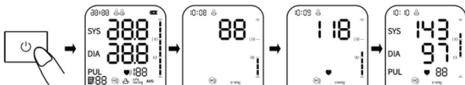
Nota: Si se siente incómodo durante la medición, presione el botón "⏻" inmediatamente para detener la medición. Cuando la presión del aire alcanza un valor determinado, el valor en la pantalla disminuirá lentamente a una velocidad determinada y el símbolo del latido del corazón parpadeará. Una vez completada la medición, las mediciones de presión sistólica, presión diastólica y frecuencia de pulso se mostrarán en la pantalla.
