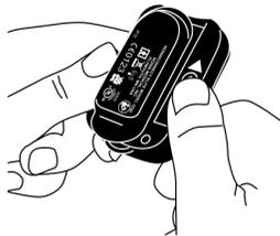
3. Faites glisser le volet du compartiment des piles dans la direction opposée et retirez-le du modèle 3240.
