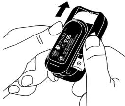
4. Le cas échéant, retirez les piles du modèle 3240. Mettez les piles au rebut de manière conforme aux réglementations.
